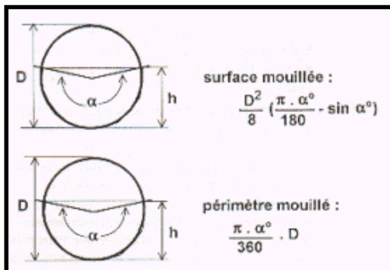
Le périmètre mouillé est la partie du périmètre de la section mouillée qui est en contact avec les parois de la conduite.
