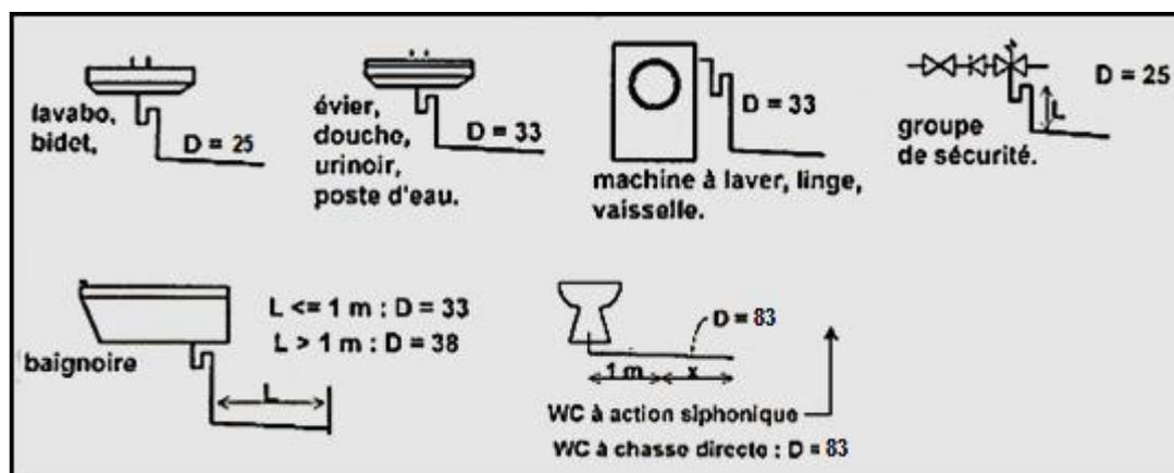
Le diamètre intérieur du branchement de vidange doit être au moins égal à celui du siphon qu'il reçoit.
