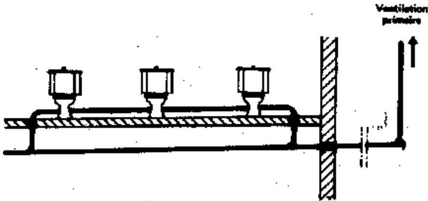
Les ventilations primaires de plusieurs chutes peuvent être regroupées en une seule immédiatement au-dessus du dernier branchement. Le diamètre de cette sortie étant le diamètre immédiatement supérieur au diamètre de la plus grande des ventilations avant regroupement, la ventilation secondaire n'est exigée en aucun cas.
