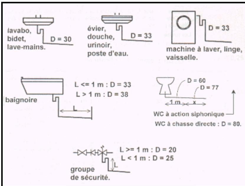
Les diamètres indiqués dans les tableaux ci-dessus sont prévus pour des pentes de canalisation comprises entre 1 et 3 cm/m.
