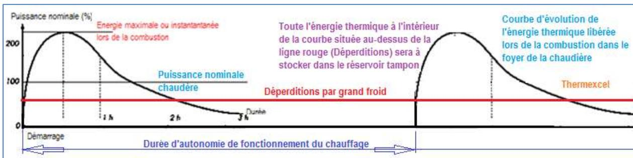
Si la puissance nominale (en kW) de la chaudière bois doit être supérieure aux déperditions, mais c'est surtout le volume du foyer qui a son importance. Une chaudière de 20 kW avec un foyer de remplissage de 60 litres ne dégagera pas autant d'énergie thermique qu'une autre avec un foyer de 100 litres, donc il faudra prévoir plus de remplissage de bois par jour.
